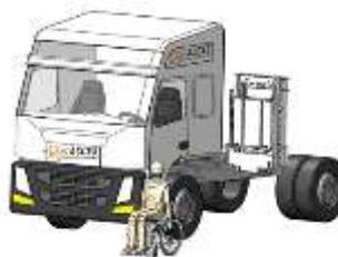
Il ou elle se positionne en avant de véhicule et actionne le déploiement du dispositif. (Sortie du gabarit)
