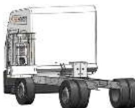
La plateforme se replie, bascule et se rétracte derrière la cabine. Le process est automatisé
