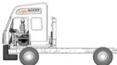
Le conducteur(trice) télescope la plateforme, met son fauteuil en parallèle du siège conducteur, puis se transfère manuellement sur le siège
